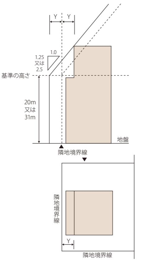
※ Y=基準の高さを超える部分の隣地境界線から建物までの最短距離
