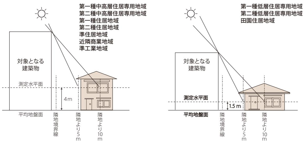
福岡県内の各時刻における冬至日の影の長さは、平均地盤面からの建築物の高さに北緯 $33^{\circ}\sim 34^{\circ}$ における影の倍率を乗じて求めます。
